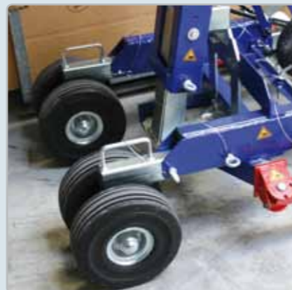
Bessere Lastverteilung durch Doppelbereifung, optional möglich.
