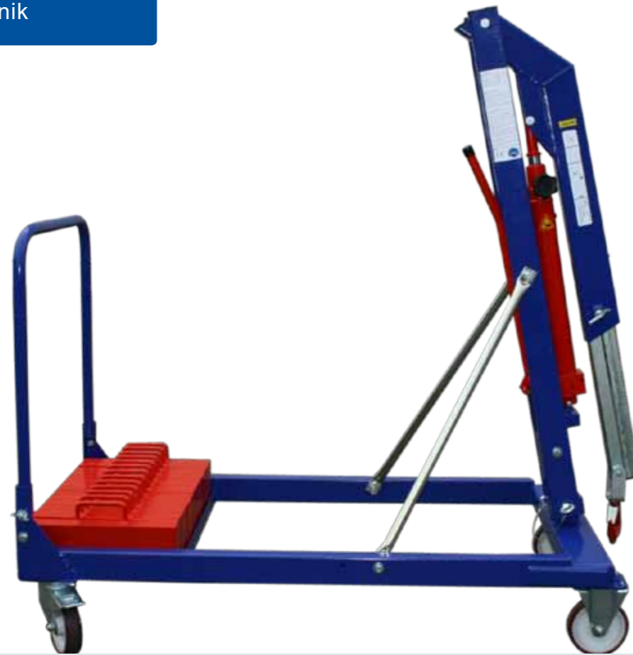
Zusammenklappbarer KS GK 330 mit abnehmbaren Kontergewichten
