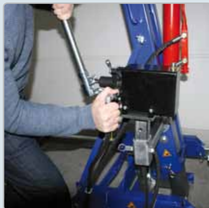
Hydraulikpumpe an zwei Positionen montierbar: am Ausleger oder neben den Boxen.
