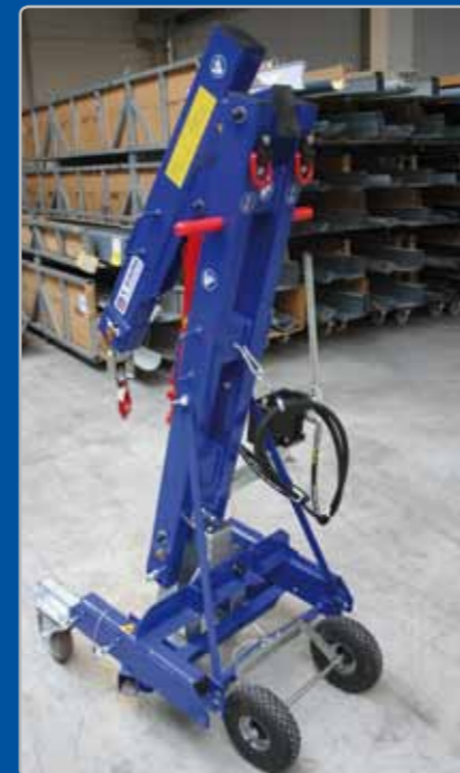
Klappmechanismus mit großen Transportreifen für Transport im Fahrstuhl.
