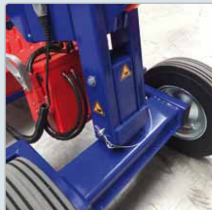
Klappmechanismus an der Vorderachse für den Transport zur Baustelle
