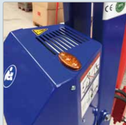
Signalleuchte weist rechtzeitig darauf hin, dass der Akku geladen werden soll
